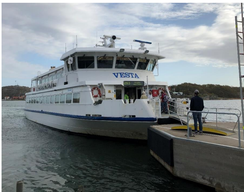
Figur 9. Båt i linjetrafik som lagt till vid befintlig kaj för persontrafik. På bilden ses även rampen mellan kajen och båten (Bildkälla: COWI AB).
